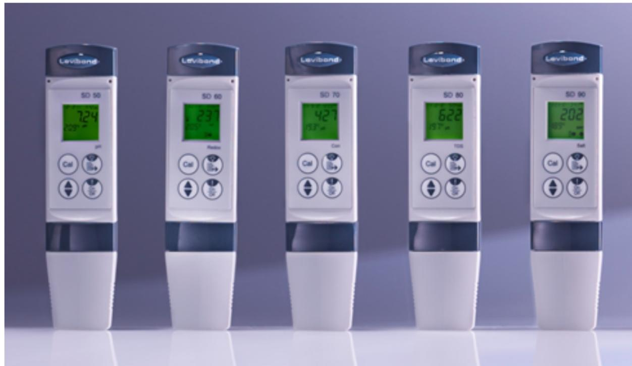
Los cinco modelos tienen integrado un sensor de temperatura con un rango de medición de 0 a 60 °C.
