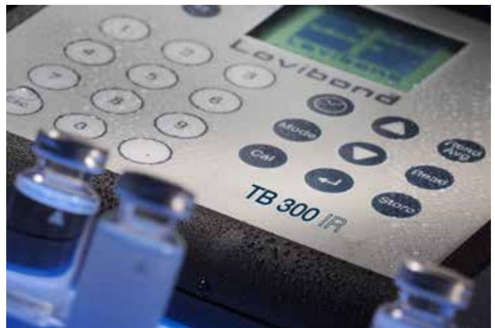
El turbidímetro TB300 IR está diseñado para efectuar mediciones en un rango de 0.01 a 100 UTN en muestras de agua en laboratorio, utiliza una fuente de luz infrarroja y de incidencia a 90° de detección, permitiendo la medición de muestras incoloras como coloreadas.
