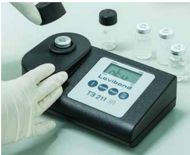
El turbidímetro TB 211 IR permite determinar análisis rápidos y exactos en sitio. Con un rango de medición entre 0.01 y 1100 UTN, mediante un procedimiento de luz difusa de 90°, al ser infrarrojo es posible realizar mediciones de agua coloreadas como incoloras.
