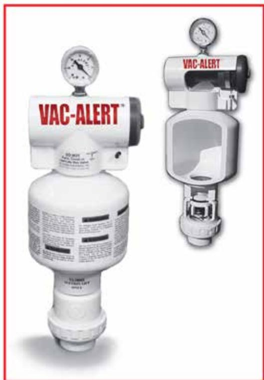
El Vac-Alert es un sistema de seguridad de liberación de vacío que no requiere energía eléctrica. Cuando un bañista es atrapado por la fuerza de succión generada por el sistema de circulación, se produce un vacío en la tubería. Al contar con un sistema de pistones que detecta dicho vacío, permiten la entrada de aire a la línea de succión liberando al usuario.
